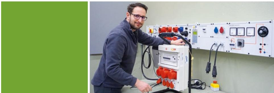
Mauro Puzzo, eidg. dipl. Elektroinstallateur, bei der periodischen Prüfung von Baustromverteilern.
